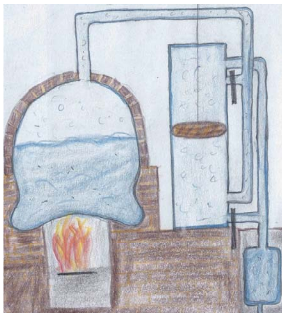
図1 『プロメテウス』1769年にジェームズ・ワットが特許を取得した蒸気エンジンの原理を示す (著者の娘によるイラスト)
