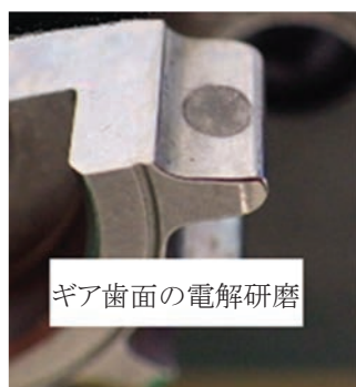
写真4 ギア歯面の電解研磨例
