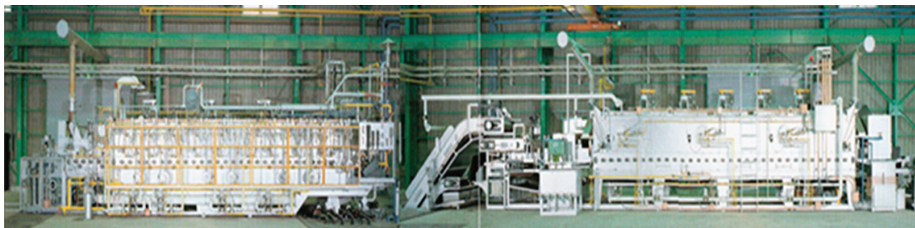
写真 1 従来型のメッシュベルト式連続熱処理炉ライン
